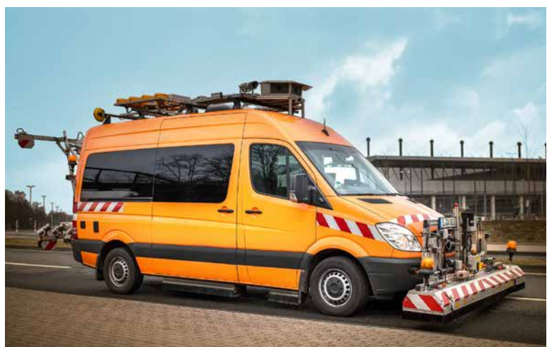
Multifunktionales Messsystem zur Erfassung des oberflächigen Fahrbahnzustands
